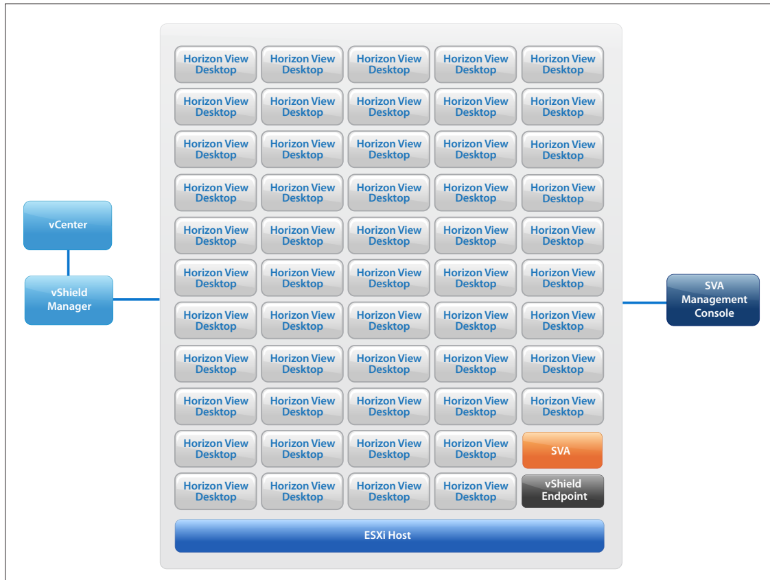
Figure 2: vShield Endpoint: One SVA per Host Instead of One AV Agent per Desktop
