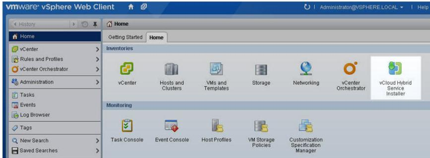
インストーラは、指定された認証情報を使用して My VMware に接続し、vCloud Hybrid Service プラグインをダウンロードし、それを vSphere Web Client にインストールします。インストーラは常に、使用可能な最新バージョンのプラグインをインストールします。
