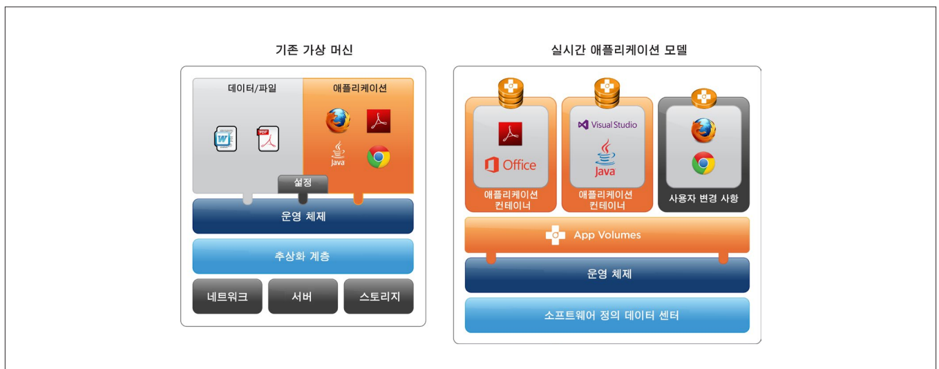
App Volumes 관리 가상 머신은 OS보다 위에 가상화됩니다. 애플리케이션, 데이터 파일, 설정, 미들웨어 및 구성 라이선스는 별도의 계층 역할을 수행합니다.
