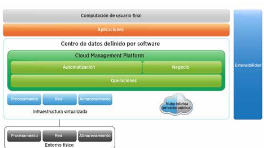
Figura 2: La plataforma de administración de nube de VMware es el plano de control para el centro de datos definido por software
