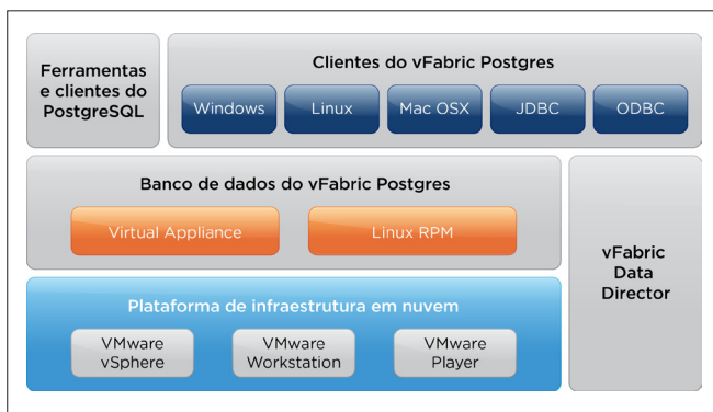
Componentes e implantação do vFabric Postgres
