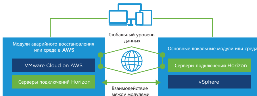
Рис. 2. Архитектура облачных модулей Horizon может быть распределена между локальной средой и AWS
