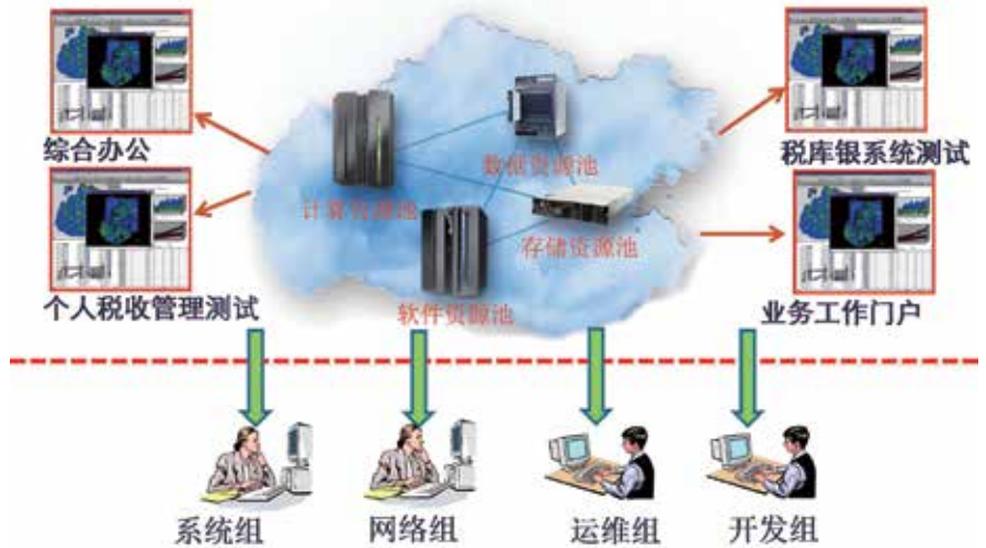
图：北京国税信息中心内部测试云平台架构
