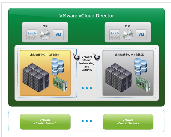
VMware vCloud Director 提供了一种实用的方法，可将运行 vSphere 的现有数据中心转化为值得信赖的“基础架构即服务”环境，从而实现自动调配。
